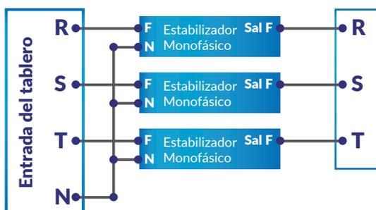
Salida estabilizada tipo triángulo.
